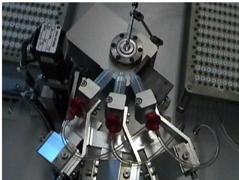
Illustration 2: Système d'encrage à 3 seringues
