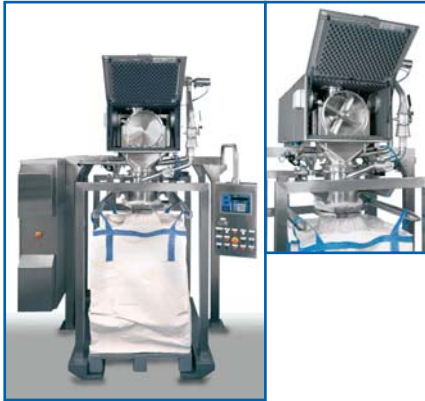
Pharmawirkstoff Vermahlung und Abpackung in Big Bag
