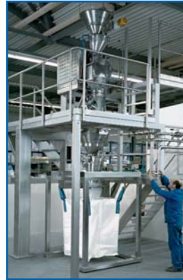
Osteoporosemedikament Feinvermahlung inkl. Dosierung
